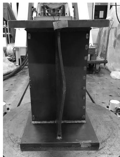
図-6 圧縮試験後の残留たわみ
