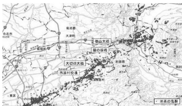
図-1 熊本地震により生じた亀裂分布と分析対象橋梁
