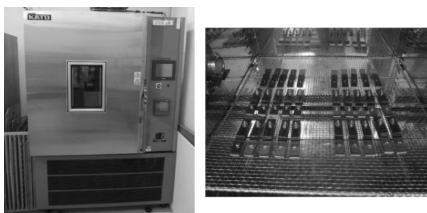
写真-2 加熱・加湿処理機と養生状況
