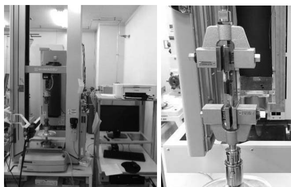
写真-6 精密万能試験機（引張せん断試験）
