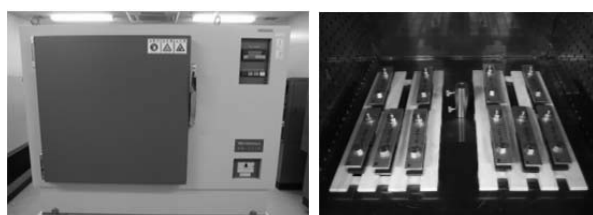
写真-1 老化試験機と養生状況
