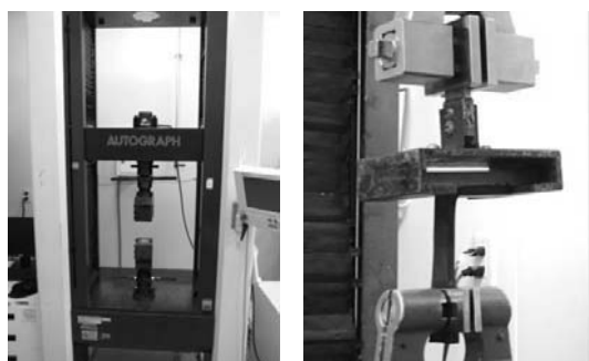
写真-8 精密万能試験機 (90°Cはく離試験)
