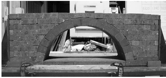
(a) 壁石を有する石アーチ模型の全体
