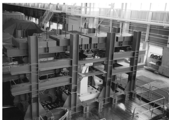
写真-1 免震支承とRC橋脚がともに非線形化した振動実験概況 17)
