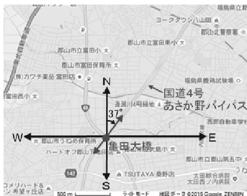
(1) 亀田大橋の橋軸方向と橋軸直角方向
