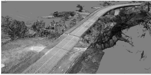
図-2 大切畑大橋端部の点群データ
