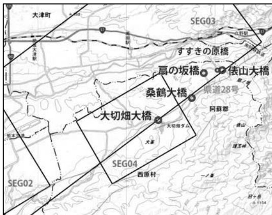
図-3 推定した震源断層の位置と周辺の被害橋梁
