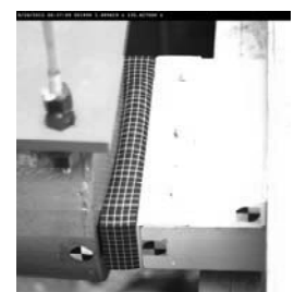
写真-4 緩衝材の変形状況 (高速カメラ画像)
