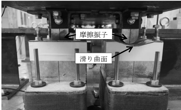
写真-2 供試体設置状況（橋軸方向）
