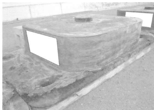
写真-1 取出し後の支承状況
