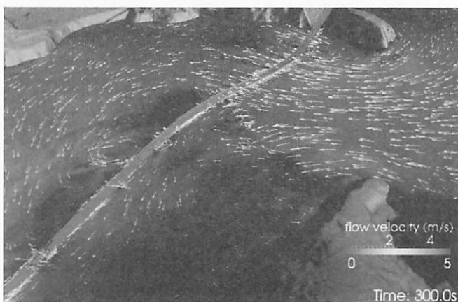
図-5 3次元津波解析により得られた流速分布の例
