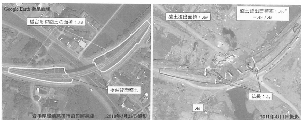
図-3 Google Earthの衛星画像に基づく橋台周辺盛土の面積 A_e 及び橋台周辺盛土の流出面積 A_w の算定（左は被災前、右は被災後の衛星画像を示している）
