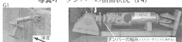
写真-7 ダンパーの損傷状況 (P4)
