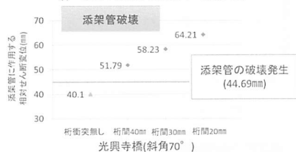
(b) 桁間距離による破壊判定
