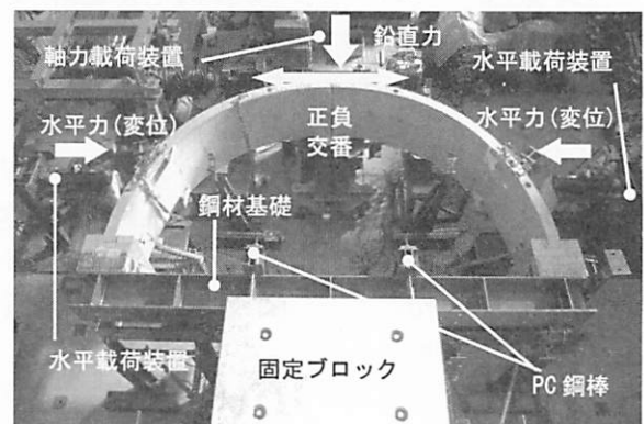
写真-3 供試体設置概要写真 (3 ヒンジアーチ)
