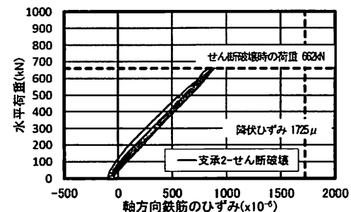
図-8 載荷点位置における水平荷重と橋脚下端の軸方向鉄筋のひずみの関係
