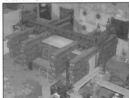
写真－4 応急復旧後の載荷実験のセットアップ状況
