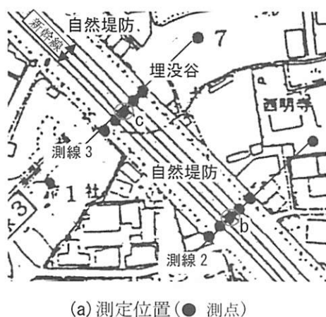
図-18 下食満高架橋の常時微動測定結果 19)
