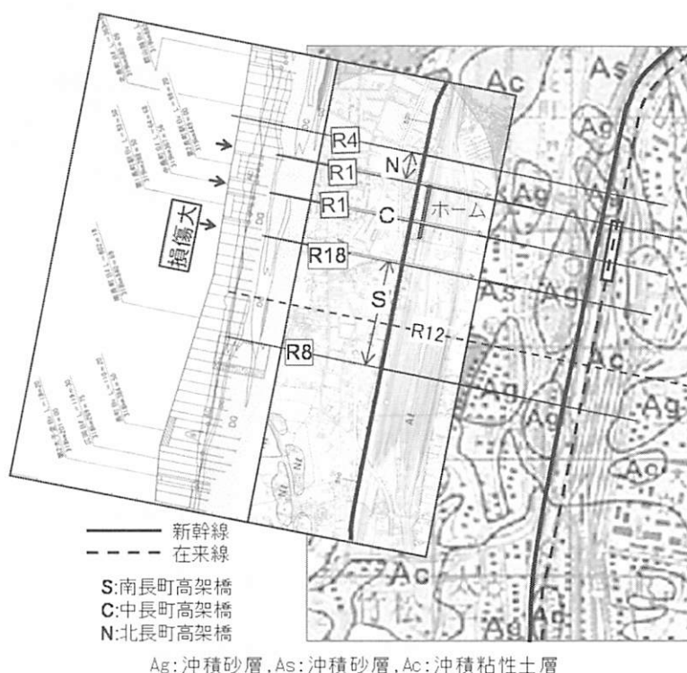
図-12 長町高架橋の被害と地盤地質の関係(文献13)と14) を集成、加筆)
