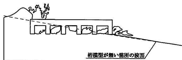
(a) 津波の作用状況
