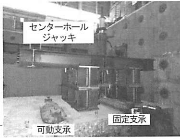
図-8 支承アンカーボルト引き抜き耐力試験要領
