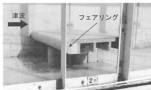
写真-2 半円フェアリングを取り付けた橋梁模型
