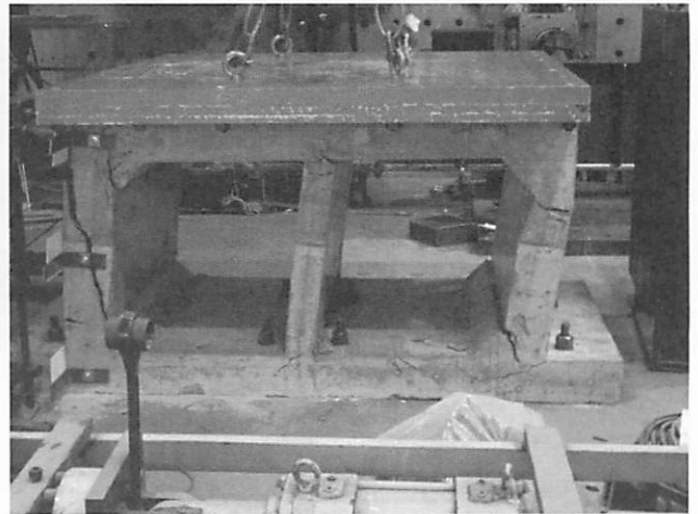
図-6 載荷終了時の損傷状況 (Case0)
