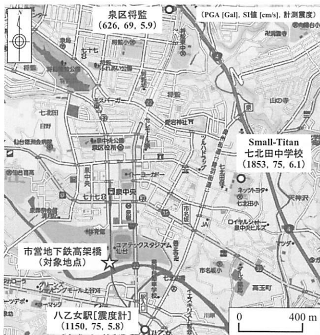
図-1 仙台市地下鉄高架橋被災地点周辺の観測点の分布
