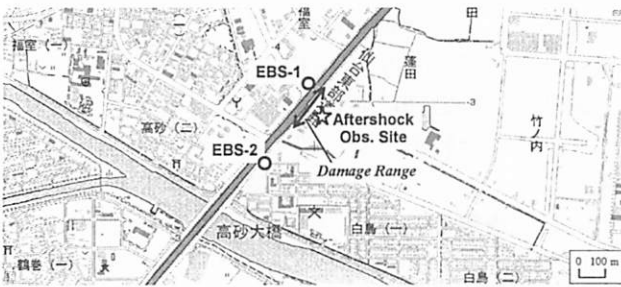
図-3 東部高架橋周辺でのボーリング地点と微動計測点
