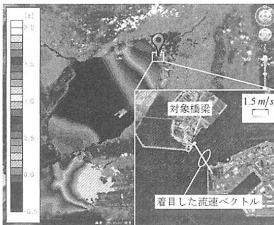
図-4 最大流速時の大阪湾の水位変化コンター図と 対象橋梁付近の流速ベクトル図
