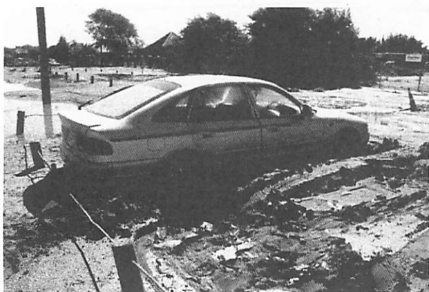
写真-11 Anzac 橋周辺で噴砂に埋まる自動車
