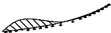
図-10 橋軸直角1次モード図と1次固有周期
