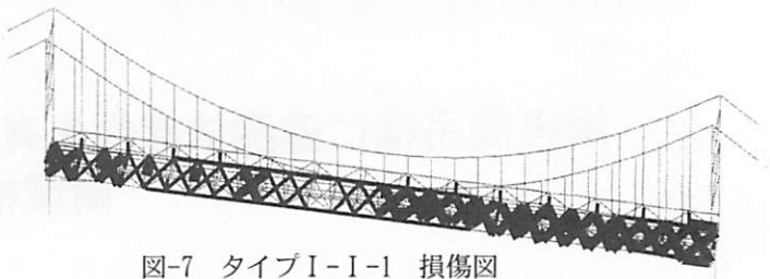
図-7 タイプI-I-1 損傷図 (直角方向加震:現況モデル)
