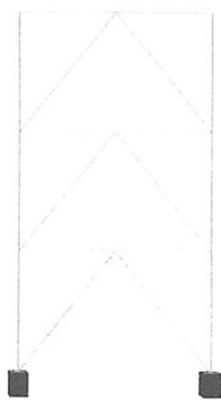
図-7 三層門型ラーメン橋脚モデル
