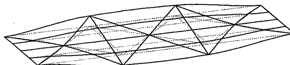
図-5 ねじり 1 次振動モード (金属支承)
