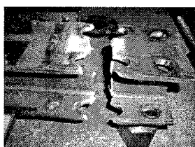
(a) 試験体 No. 1 (ボルト孔で破断)
