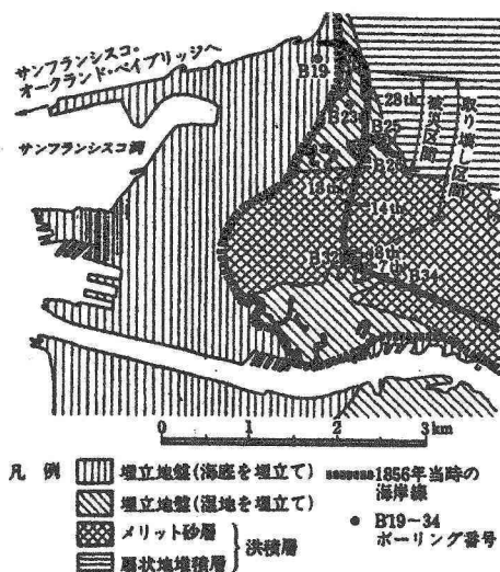
図-10 サypress高架橋周辺の地盤状態 8)9)
