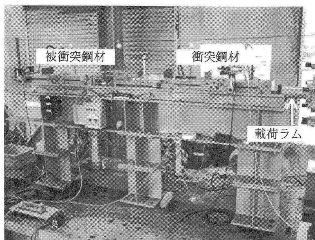
写真-1 空気浮上式ガイドレール全景
