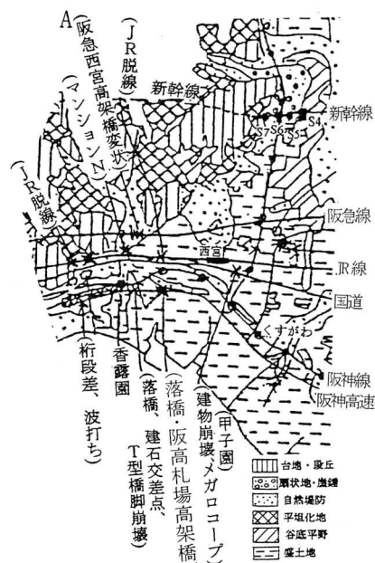
図 4 阪神高速札場高架橋付近 の地盤状態図 5) 18)
