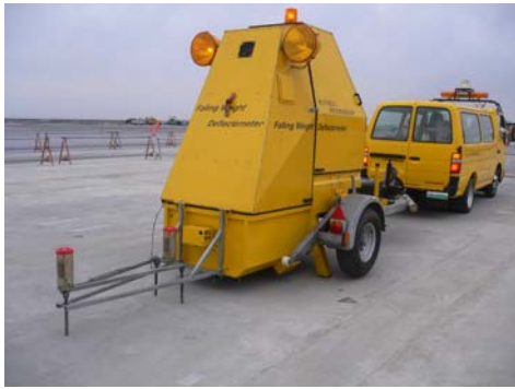
写真-1 空港舗装構造評価に対応したFWD試験機
