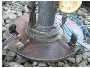
図-4 抑え鉄板と変位計
