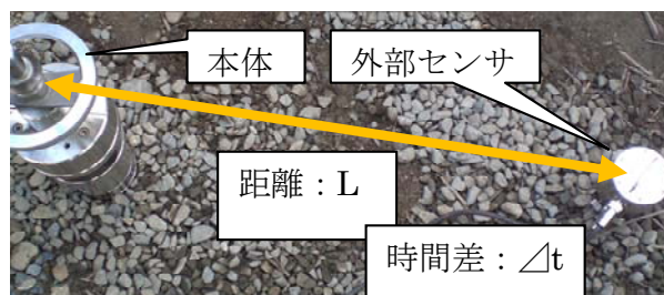
図-2 小型 FWD によるせん断速度の推定
