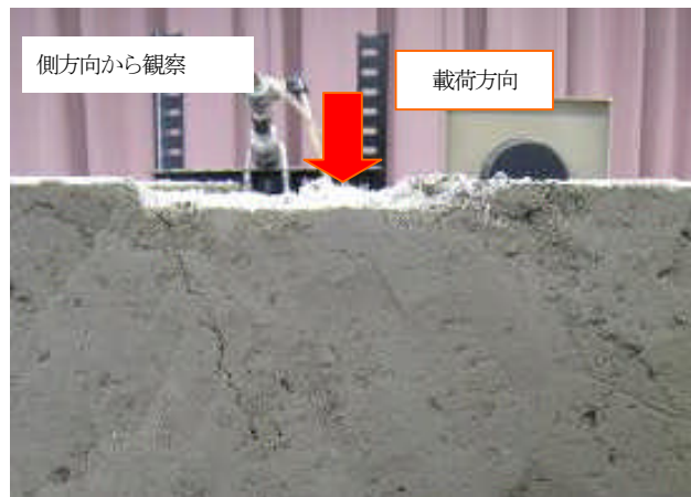
写真-2 平板载荷試験後の SGM 上载荷面（側方から）
