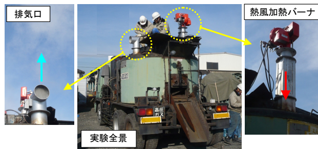
写真-2 熱風加熱バーナーと排風機
