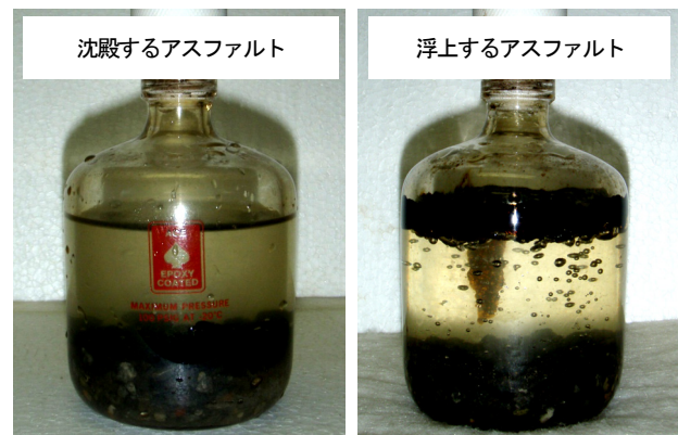
図-5 気泡連行法によるアスファルトの浮上実験
