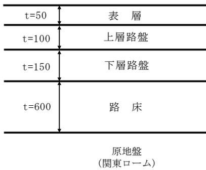
図-6 舗装構成 (単位: mm)
