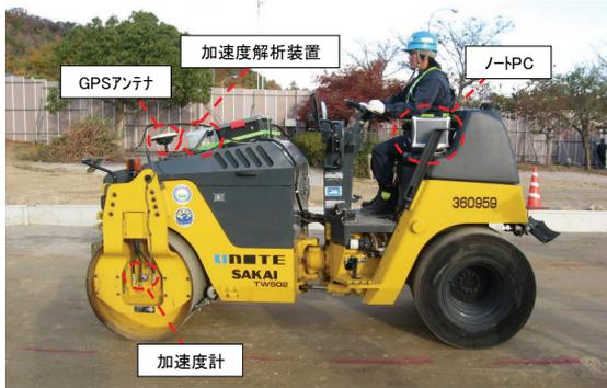
写真-1 振動ローラ (4トンコンバインドローラ)
