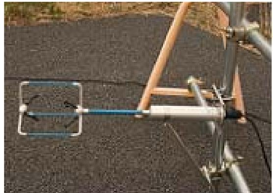
図-3 3次元超音波風速計
