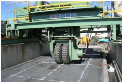
写真-1 促進荷重試験機の概観
