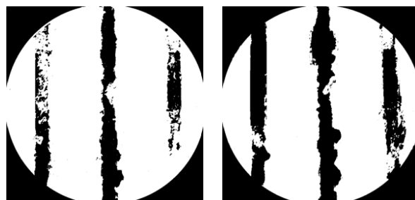
写真-8 乗用車荷重载荷後の氷板破碎状況
