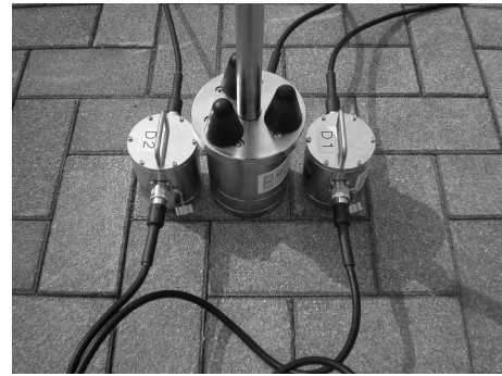
図-13 小型 FWD による測定状況 (ヘリングボーン配置)
