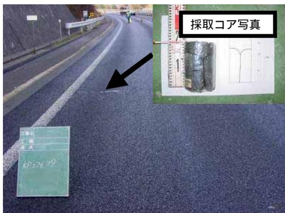
写真-1 高機能舗装の層内損傷例
