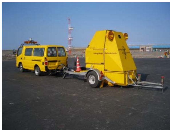
写真-3 空港舗装対応 FWD 測定機
