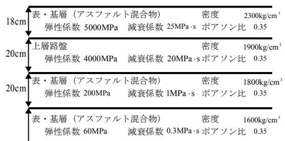
図-1 舗装構造と材料定数の真値
