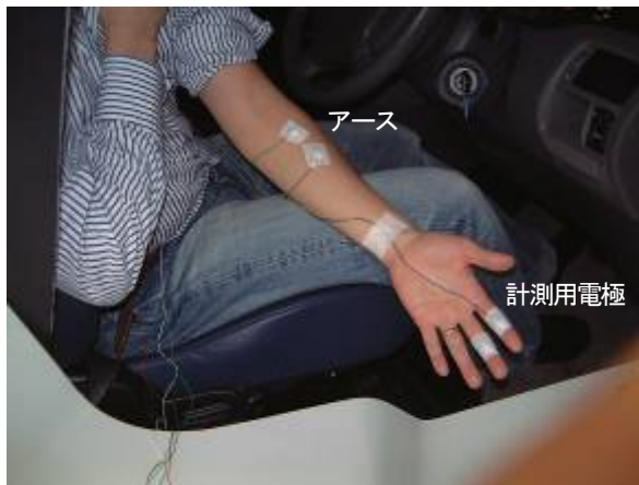
写真-2 皮膚伝導反応計測用電極の貼り付け位置
