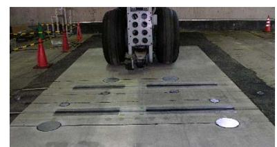
写真-1 輪荷重走行載荷試験の状況
