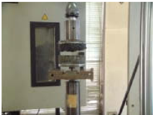
写真-5 円筒供試体の引張試験状況
